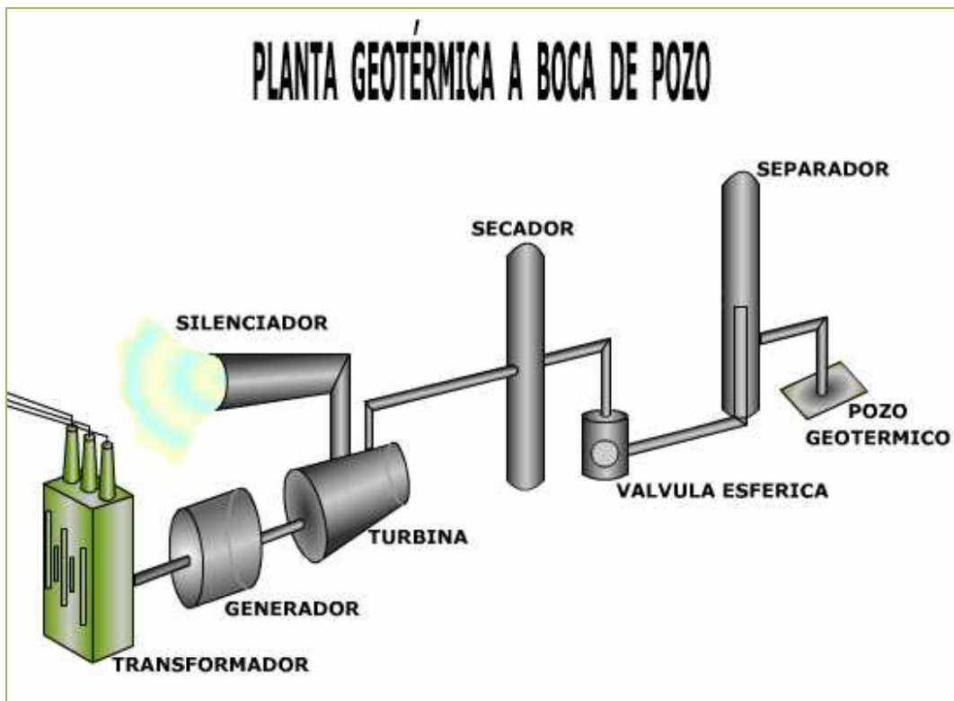
Ilustración 11 Esquema planta geotérmica a boca de pozo a contrapresión (1).
